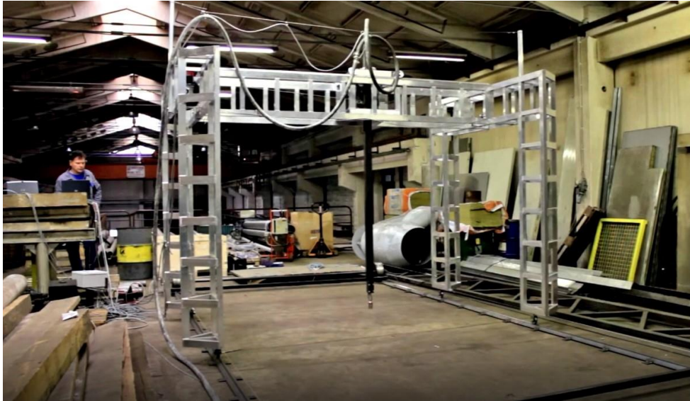
1 pav. Pramoninis 3D spausdintuvas „BetAbram P1“, skirtas pastatų statybai Šaltinis: https://www.3printr.com/top-10-largest-3d-printers-0535270/ 2023
