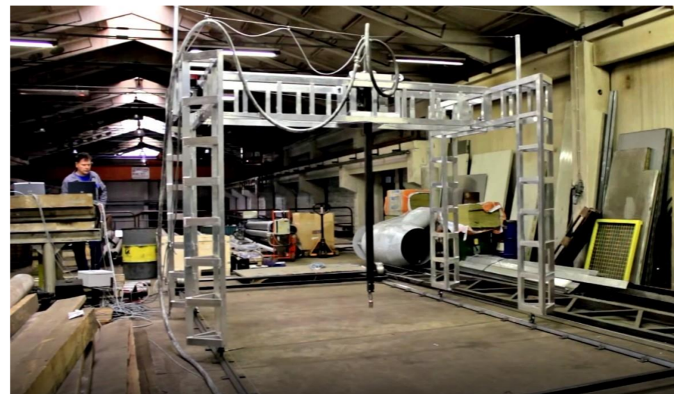
1 pav. Pramoninis 3D spausdintuvas „BetAbram P1“, skirtas pastatų statybai Šaltinis: https://www.3dprinter.com/top-10-largest-3d-printers-0535270/ 2023
